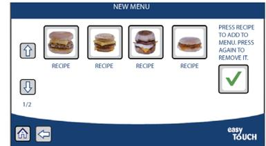
8. Utilisez les flèches orientées vers le haut et vers le bas pour monter ou descendre dans la liste l'étape sélectionnée. Appuyez sur la coche pour continuer.
