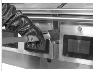
**Récure des canaux de rigoles pour grills à châssis unique**
