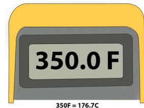
14. Utilisez les flèches orientées vers le haut et vers le bas pour régler la compensation sur l'écran. L'ordinateur effectue les calculs nécessaires pour ajuster la température affichée à l'écran.
