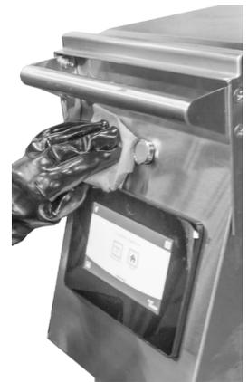
26. Essuyez les surfaces latérales du grill à l'aide d'un chiffon pour grill propre imbibé de désinfectant. Veillez à toujours nettoyer dans le sens du grain. Ne retirez en aucun cas les panneaux. Si de la graisse pénètre dans le grill, faites appel à un technicien.
