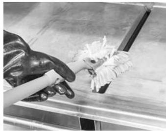
**Pour les grills à châssis unique, rincer le canal de la rigole.**
