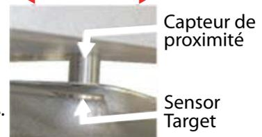
Le capteur de proximité est utilisé pour détecter la position du plateau à l'aide du capteur cible fixé au capot du plateau, effectuer une « inspection visuelle ».
