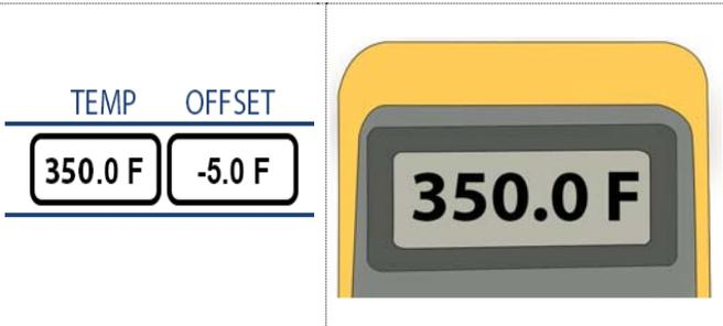
4. Réglez la température sur le contrôleur du gril afin de correspondre à la température indiquée sur le pyromètre. La flèche haut fera augmenter et la flèche du bas fera baisser à chaque fois qu'elles seront pressées et la température affichée pour la compensation changera d'un degré.
