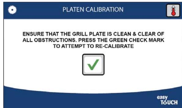
REMARQUE : si le processus échoue, un signe apparaîtra. S'assurer que rien n'interfère avec le processus et appuyer sur la coche pour un autre essai de recalibration.
