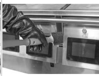
**Pour les grills à châssis unique, récurer le canal de la rigole.**
