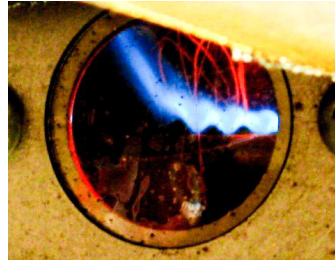
Aşırı hava ile alevi yükseltme işlemi
