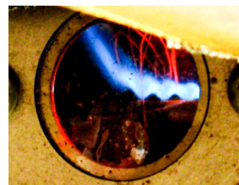
Podnoszenie się płomienia z powodu zbyt dużej ilości powietrza
