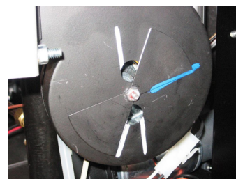
Podnoszenie się płomienia z powodu zbyt dużej ilości powietrza
