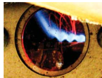
Отрывание пламени из-за слишком большого количества воздуха
