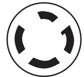
Cable de 30 amperes, 4 cables, trifásica (SÓLO parrillas eléctricas)
