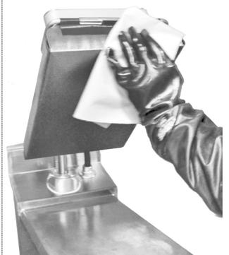
9. Limpie la superficie de la lámina de material antiadherente. Humedezca con limpiador de parrillas un paño limpio y empapado en desinfectante y limpie la superficie expuesta de la lámina de material antiadherente. Limpie todas las láminas de material antiadherente siguiendo este procedimiento.
