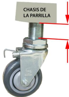
Tenga en cuenta la marca roja que hay en el vástago de la ruedecilla. La marca roja indica la posición máxima de ajuste y no debe ser visible tras realizar los ajustes pertinentes, antes de que la contratuerca esté debidamente apretada.
