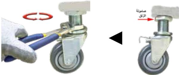
١١. حرّك صامولة الفرامل للأعلى ولا تربطها. في حالة عدم استواء الشواية، ضع كمامة مضخة في الجزء السفلي من الساق المسننة وأدبرها في اتجاه عقارب الساعة أو عكس اتجاه عقارب الساعة لرفع أو خفض ارتفاع الشواية حتى تستوي وفقاً لقراءة أداة الاستواء.
