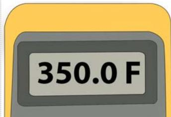
15. Stellen Sie die Temperatur an der Grillsteuerung passend zur Temperatur des Pyrometermesswerts ein. Der Auf-Pfeil erhöht und der Ab-Pfeil senkt den Offsetwert und die angezeigte Temperatur bei jedem Drücken um einen Grad..
