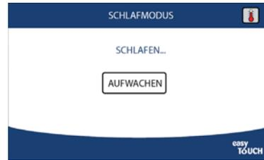
5. Der Bildschirm zeigt die Ruhezeit an (Stunden:Minuten). Um den Ruhemodus zu verlassen, drücken Sie auf dem Bildschirm auf AUFWECKEN oder die grüne Taste. Die Platte wird angehoben, der Bildschirm zur Rezeptauswahl wird angezeigt und der Grill ist betriebsbereit.
