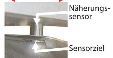
Der Näherungssensor wird zur Erkennung der Plattenposition anhand des Sensorziels verwendet, das an der Plattenhaube befestigt ist. Führen Sie eine „Sichtprüfung“ durch.
