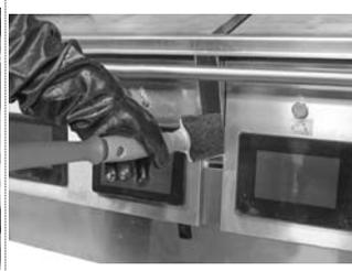
**Wannenkanal bei Grills mit Einzelrahmen schrubben.**
