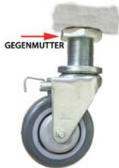
13. Die Gegenmutter anziehen, um die Position der Laufrolle zu verriegeln. Dazu sollten 2 Schlüssel verwendet werden, um sicherzustellen, dass die Laufrollen weiterhin gerade ausgerichtet sind.
