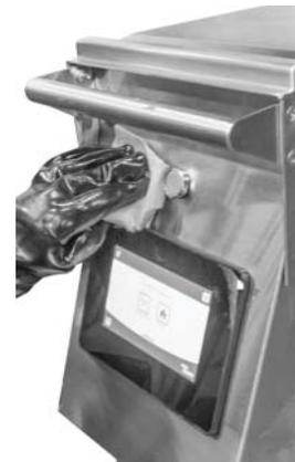
27. Wischen Sie die seitlichen Grillflächen mit einem sauberen, in Hygienelösung angefeuchteten Grilltuch ab. Reinigen Sie immer in Richtung der Maserung des Metalls. Entfernen Sie niemals Wände. Wenn Fett in das Innere des Grills gelangt, muss ein Wartungstechniker zwecks Unterstützung angefordert werden.
