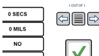
Durch Drücken des Rechtspfeils erhalten Sie eine Option, mit der dem Rezept ein Schritt hinzugefügt werden kann.
