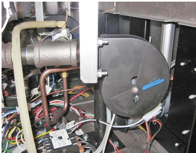
4. A partir de un arranque en frío, encienda la zona correspondiente al quemador que está comprobando y déjelo encendido durante 1 minuto para que se estabilice. Si la parrilla ya está precalentada, agregue una carga a la superficie para mantener el quemador funcionando durante varios minutos. Con el quemador funcionando, ajuste el obturador de aire en una posición más cerrada hasta que la llama comience a elevarse o a flotar separada de la superficie del quemador.
