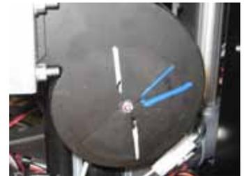
6. Rotieren Sie die Luftklappe auf eine etwas mehr geöffnete Einstellung, bis die Flamme ihre blaue Kegelform verliert oder sich verlängert. (auf ungefähr die doppelte Höhe). Ziehen Sie auf der Ventilatorfront entlang der Luftklappe von der Luftöffnung bis an das Ende des Luftklappeflügeleinstellers eine Linie. Dies ist der „obere“ Referenzpunkt. Wenn die Luftklappe vollständig geöffnet ist, bevor sich die Flamme ändert, markieren Sie die Linie an dieser Position.
