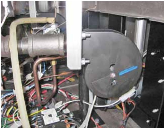
4. Schalten Sie die betreffende Zone für den zu prüfenden Brenner im Kaltstart ein und lassen Sie sie 1 Minute lang brennen, damit sie sich stabilisiert. Wenn der Grill bereits vorgeheizt ist, stellen Sie eine Verbraucherlast auf die Grilloberfläche und lassen Sie den Brenner einige Minuten lang brennen. Wenn der Brenner läuft, stellen Sie die Luftklappe auf eine etwas mehr geschlossene Position, bis sich die Flamme von der Brenneroberfläche hebt.
