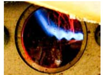
Abhebende Flamme bei zu hoher Luftzufuhr
